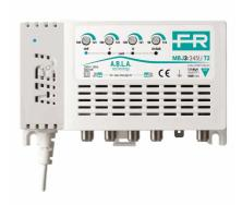
Centralino con 1 ingresso (III+DAB+IV+V) da interno autoalimentato con guadagno 25dB e livello di uscita fino a 115dBµV in banda UHF, amplificazioni a bande separate, regolazioni del livello (20dB) indipendenti per ogni banda e bassa figura di rumore. Tecnologia T2 con filtro integrato per eliminare le interferenze 5G a 694MHz.
